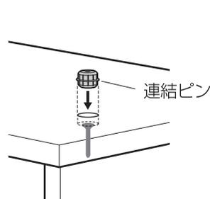
**3** 連結ピンの取り付け位置に底板の穴を合わせ、はめ込みます。
