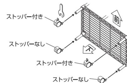
ストッパー付きのキャスターは前側に取り付けてください。ポール下側の取り付け穴にキャスターを取り付けます。※キャスターは付属のスパナを使用してしっかり締め付けてください。
