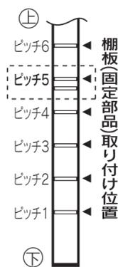
※下から5ピッチごとに目安の溝が2本入っています。棚板固定部品は上側の溝に取り付けてください。
