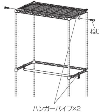
全体をもう一度立て、最上段の棚板とコの字バーにハンガーパイプを取り付けます。ハンガーパイプ固定金具を引っ掛けます。中央の線材に固定金具がはまるように左右の外側から引っ掛けてください。位置を確認したら、ハンガーパイプをねじで固定してください。⊕ドライバーを使用してしっかり締め付けてください。
