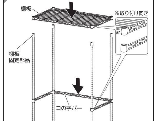
全体を立てて、2と同様にポールに棚板固定部品を取り付け、コの字バー、最上段の棚板の順に取り付けます。
