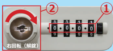
①に任意の暗証番号をセットし、 ②のキーシリンダーを右回転させ解錠します。
