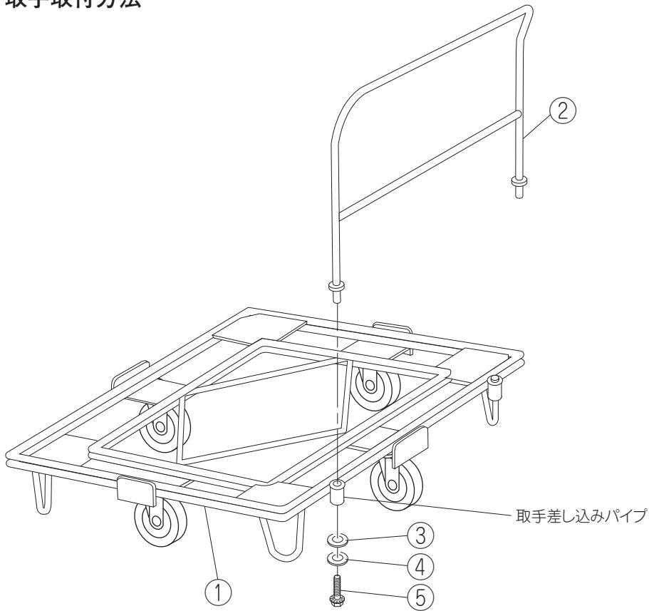
・取手②を台車本体①の取手差しこみパイプに合わせてはめ込み、平座金③、バネ座金④、六角ボルト⑤にてはずれない様に締付けて下さい。
