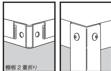
●棚板コーナー部は、サカエ独特の支柱側面突き合わせ型及び、2重折り構造のためくらつきが無く、また、棚板の強度も強く、非常に堅牢です。
