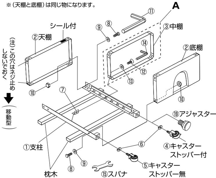
キャスターの取付けは、⑥パネ座金をはめ込み付属のスパナで締め付けます。
