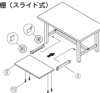
棚受⑨を本体内側の角穴に差し込みます。(後面から差し込んで、前面をたたき込む様に組付けて下さい) 中棚⑧をセットした後、ストッパー用ボルト⑩を付属の六角レンチ⑪で取付けて下さい。
