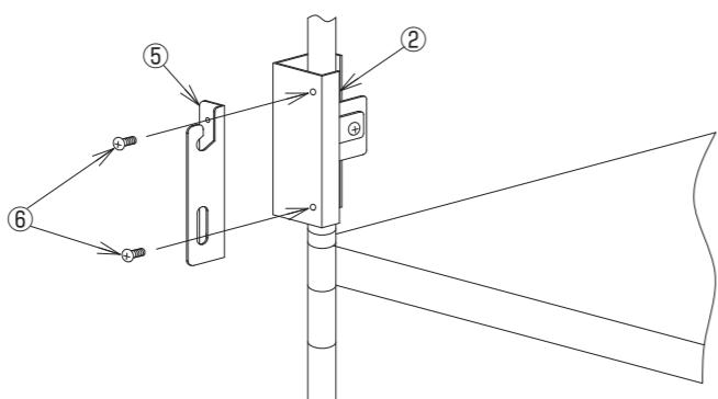
④ 両側のバー受金具⑤にバーエンドキャップ⑦と落下防止バー⑧を差し込んだものを取付けて下さい。※落下防止バー取付後、落下防止バーの動きが固いまたは緩い場合には支柱取付金具②を回すように動かして調整して下さい。
