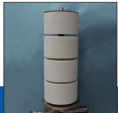
熱処理後もセルの変形なし
