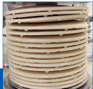
熱処理後のセルの変形
