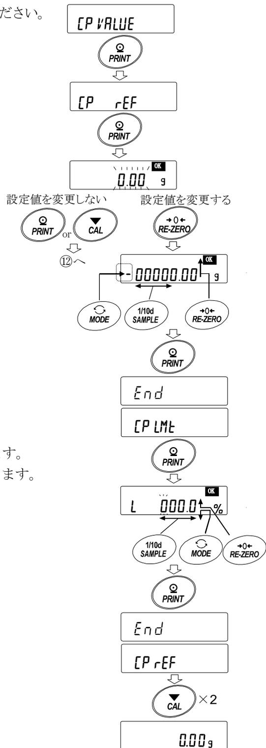
**設定例2 ゼロ付近も含め安定時・オーバ時に比較、上下限值、荷重入力**
