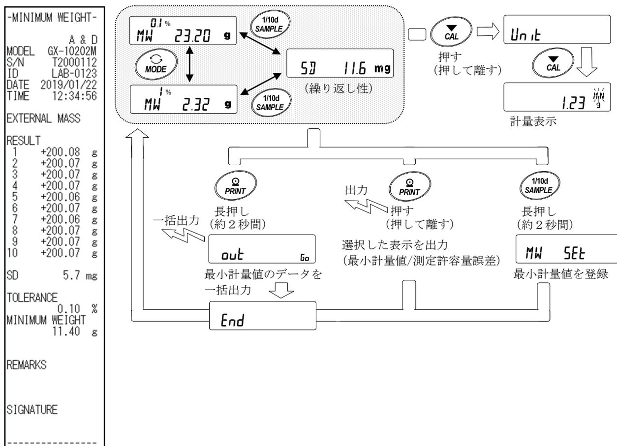
⑱ **PRINT** キーを押すと、⑰で選択した表示（繰り返し性 (**SD**)、最小計量値 (**MW**)) を出力します。
