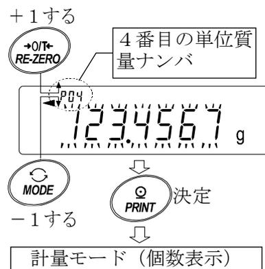
③ **PRINT** キーを押して使用する単位質量を決定し、計量モード（個数表示）へ戻ります。
