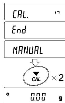
⑨ 補正に使用した分銅を載せて正しく補正されたことを確認してください。
