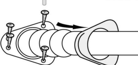
お風呂ですりのカバーを外してネジで締めつけて固定した後カバーを付けてください
