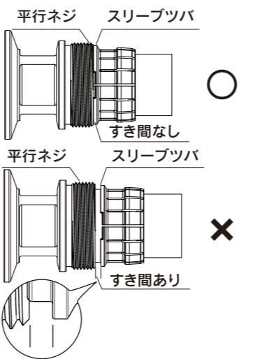
⑤ニップルの平坦部を他の「モンキー(モーター)レンチ」で固定し、袋ナットをすき間がなくなるまで締め上げてください。
