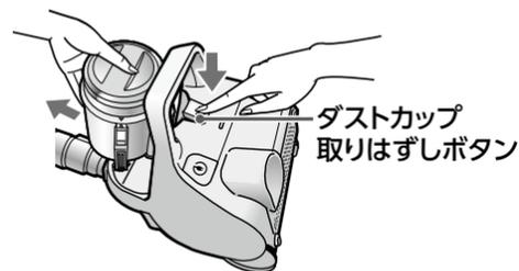
②ダストカップカバーを矢印の方向に回し、「ひらく」の○に合わせてはずす
