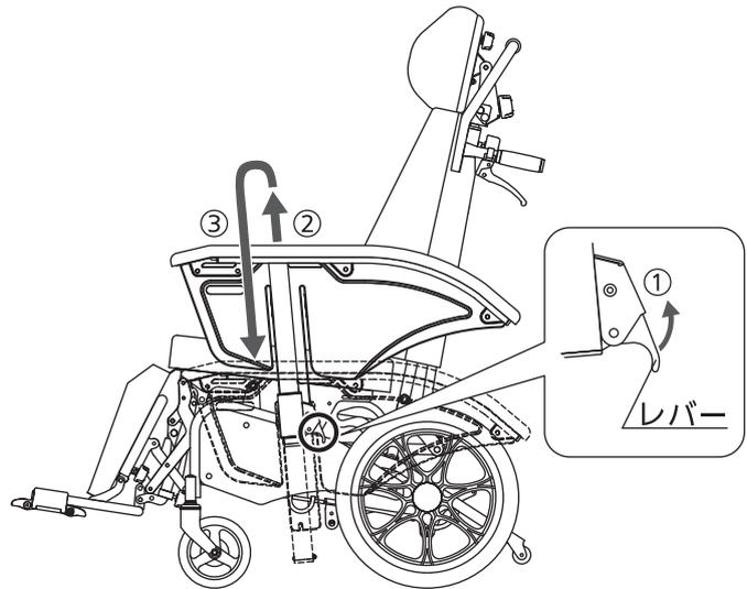
ホルダー上部に見えている穴の数を合わせることで、左右のアームサポートの高さを簡単に揃えることができます。
