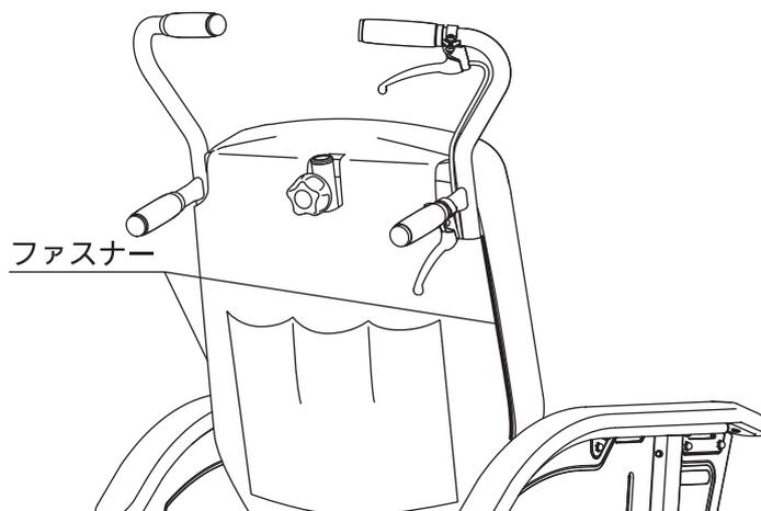
Ⅳ. ヘッドサポートを差込み、ツマミを締付けて固定します。
