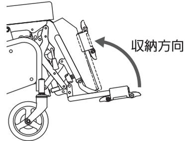
レッグサポートの角度が最低位るとき、レッグサポート裏側にある収納用ノブを引っばるとレッグサポートの固定ロックが解除されるので、そのまま押込むと収納できます。レッグサポート連動設定のリクライニング仕様のときは、バックサポートを完全に起こしたときに収納できます。レッグサポート単独設定のリクライニング仕様のときは、リクライニングの角度に関係なく収納できます。
