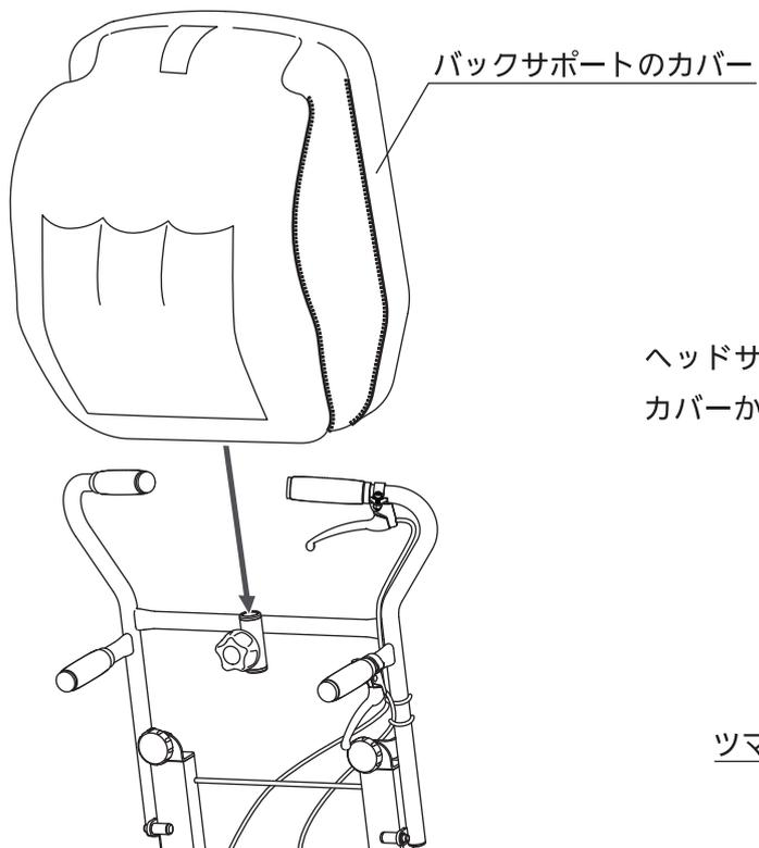
ヘッドサポート取付け部のパイプとツマミをカバーから出します。
