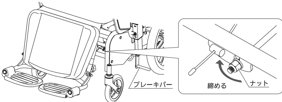
②後輪タイヤには、多少のゆれがあります。ブレーキ解除時に後輪タイヤを回転させ、ブレーキバーに干渉していないか確認してください。干渉している場合は、上図矢印の反対に回すことでブレーキバーが離れます。
