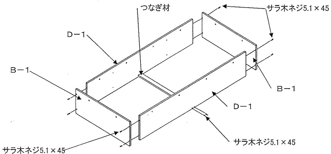
3. 設置位置に配置し、ボックス同士を接続させる場合は、ジョイントボルトを用いて接続して下さい。ジョイントしない面の穴にはキャップを取り付けて下さい。
