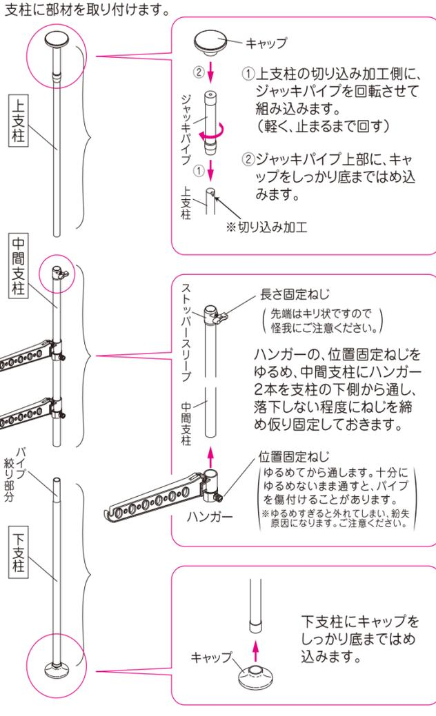
① 上支柱の切り込み加工側に、ジャッキパイプを回転させて組み込みます。(軽く、止まるまで回す)
