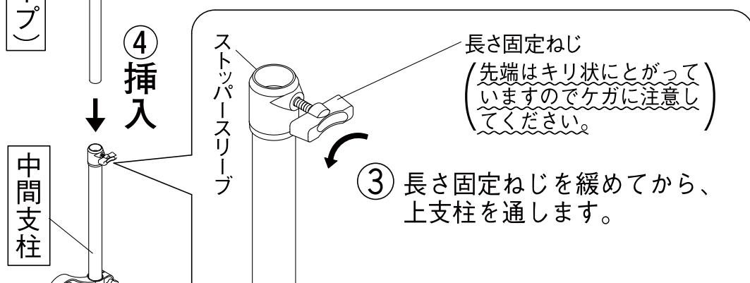
※移動・設置時には、下支柱が抜けないように下支柱を持って作業を行ってください。
