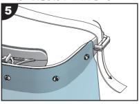
シールドを取付け終わったら、付属のゴムひもを本体端のガイド部分の内側の隙間に上から通します。
