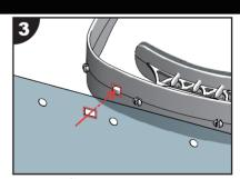
防曇面が顔側になるようにフレーム の四角の突起とシールドの四角の穴 を位置合わせします。
