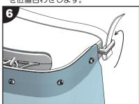
次にゴムひもの余りを外側の隙間の 切り込み部分に後ろから通します。 反対側も同様に取付けて、お好みの 長さに調整してご使用ください。
