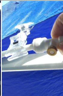
最後はホースとテント生地を自在クリップで挟むだけ
