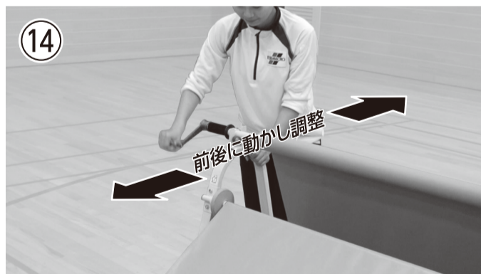
本体を前後に動かし、シートの巻き具合を調整します。この時、シートの端は常に赤いラインを越えないようにしてください。
