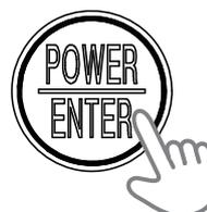
LCD が全点灯し、警報ランプが点灯してブザー音が“ピッ”と鳴るまで押してください。
