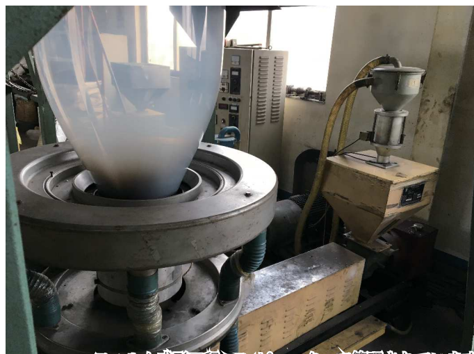
フィルム成形工程 コンピューターで管理されています
