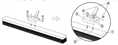
・③ジョイント金具に⑥柄をしっかりと差し込み、付属の⑦ボルト④ナット・⑤スプリングワッシャー・ワッシャーでしっかりと固定します。
