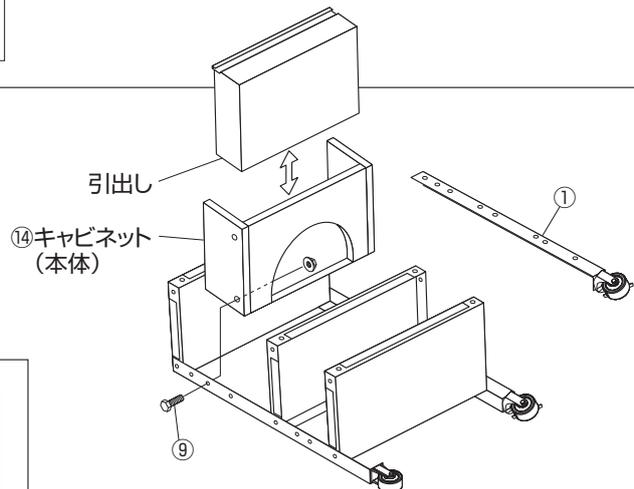
③ 水平な場所でワゴンを起こしひずみの矯正をしてからネジを強く締め付けます。
