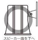
悪い取付方向の例：スピーカーが上を向いているとスピーカー面から水・油分が浸入して回路を破損する可能性があります。（防水構造ではありません）
