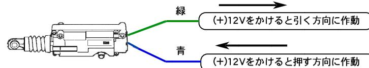
\*極性反転方式のモーターです。一方向に(+12V)をかける場合、もう一方は(-)になるよう取り付けます。
