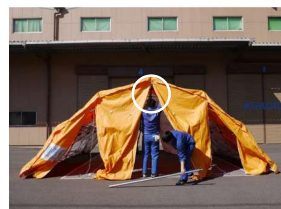
・手前と奥側を4人で同時に上に持ち上げます。中心部の人を支えて、右側の人を展開補助ポールを中心部樹脂の穴に差し込みます。
