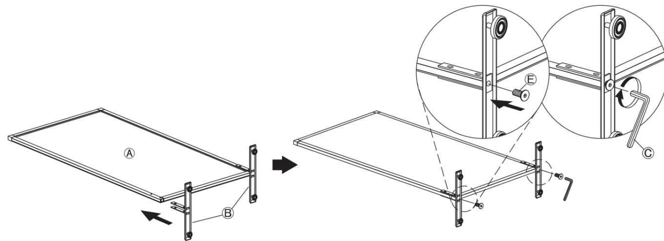
3 図の位置に 1 で外した④六角穴付きJボルト・Jナットを取り付けてください。
