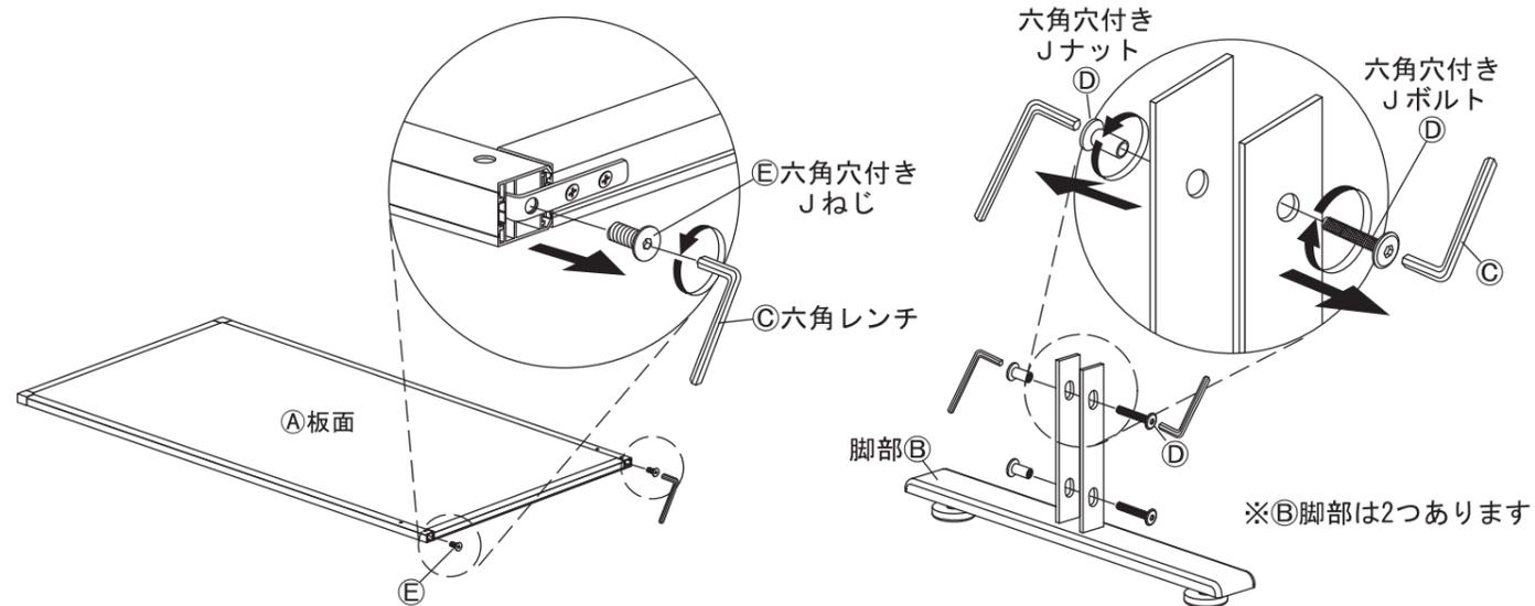
2 ①板面に 1 で取り外した⑤六角穴付きJねじを使って、②脚部を取り付けてください。
