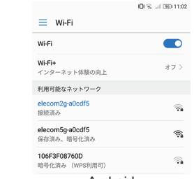
スマートフォンの本体設定から、2.4GHz帯域のWiFiネットワーク(SSID)へ接続します。このとき、サーモシステムが接続されているルーターと同様のネットワークに接続されているかを確認してください。
