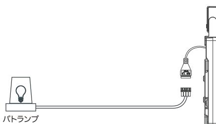
パトランプを用意し、サーモシステムのアラームポート部品へ接続します。接続方法は、ランプメーカーによって異なります。配線や電源については、ランプメーカーへご確認ください。
