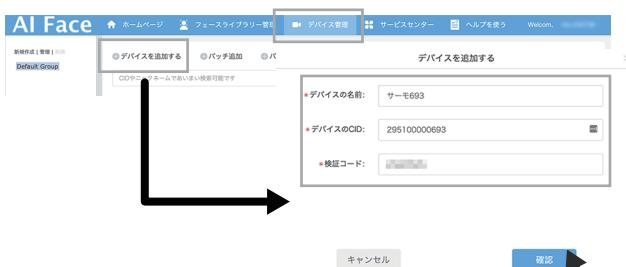
③へ戻り、ログインを完了させたら、画面上メニュー「デバイスマネジメント」→「デバイスを追加する」へ進みます。このとき、製品の「CID」と併びに「検証コード」を入力する必要があります。(製品背面ラベル要確認) 入力後正常であれば、登録完了します。
