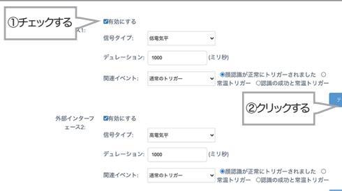
「外部インターフェイス」のチェックボックス「有効にする」を押し、「テスト」をクリックします。
