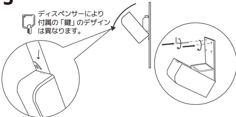
付属の「鍵」でディスペンサーケースを開き、中にあるボトルは外したうえで、引っ掛けた際のネジを締めて固定します。
