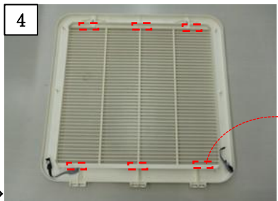
吸込口カバーにマジックテープを貼付け
