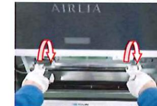
! 清潔な手袋などを使用し、ランプを直接素手で触らないようにしてください。ランプに汚れが付着すると、紫外線出力が低下し、除菌効果が得られなくなります。
