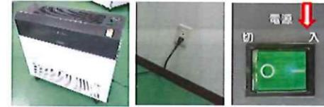
! この器具の電源はAC100Vで使用してください。誤った電圧で使用すると器具の故障により、火災・感電の原因となります。
