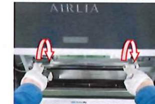
⚠ ランプを無理に取外すと、ランプ破損やソケット破損の原因となります。
