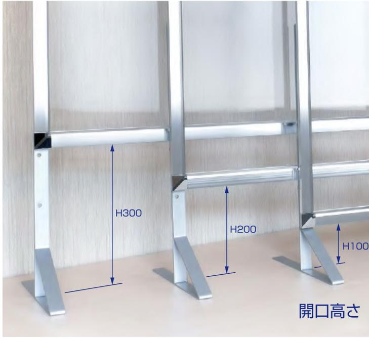
スタンドのビス固定位置をずらすことで、100/200/300mmの3段階の高さ調整が可能です。スタンドには等間隔にそれぞれの高さに対応する穴が空いています。テーブルやカウンターの高さに応じて最適な高さをお選びください。
