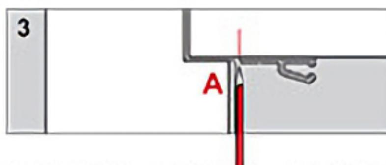
幅の広いカバー①の剥離テープをめくり下部の先端をドア枠側の水平線に貼り付けます。カバーの縁は、ドア枠に対して平行になるよう確かめて下さい。(図3a. A)
