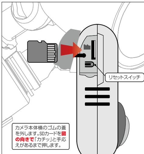
リセットスイッチ:一時的にカメラを解除する場合に使用。押すと登録待ち状態に戻ります。押した場合、アプリから登録済みカメラを解除して、再登録が必要です。
