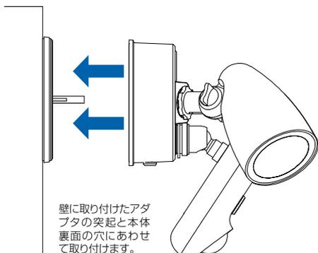
壁に取り付けたアダプタの突起と本体裏面の穴にあわせて取り付けます。
