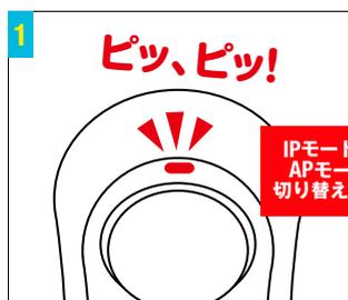
カメラの電源を入れるとインジケータランプが「ゆっくり(1秒間に約1回)」点滅をはじめ、「ピッ、ピッ!」と音がします。
