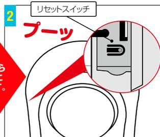
リセットボタンを約2秒間長押しするとインジケータランプが「早く(1秒間に約2回)」点滅をはじめ、「ブーン」と音がします。
