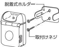
※ 脱着式ホルダーでの取付けの場合は、落下の恐れがありますので、危険な所には取付けしないでください。
