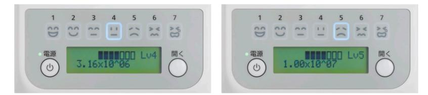
測定結果が3.16 × 10<sup>6</sup> cfu/mLのとき「レベル4」が点灯
