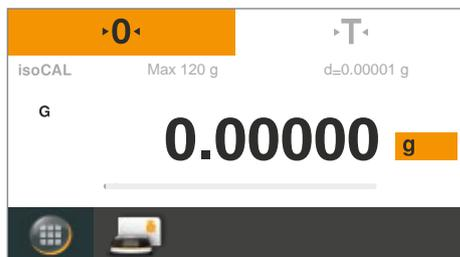
▷ どの型式でも、電源を入れたら最初に水平調節画面が表示されます。実際のひょう量画面は確定した後に表示されます。必要に応じて、天びんを水平に調節します。
