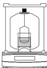
▶ 比重キットのフレームの上部ひょう量皿にサンプルを載せます。
