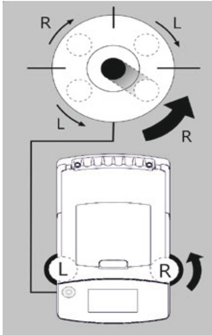
Quintix®には従来型の水準器が搭載されています。これは表示部の左側にあります。天びんが水平になっているかどうかは水準器の気泡の位置によって示されます。
