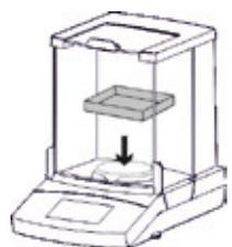
▶ 最初のサンプルの容器をひょう量皿に載せます。
