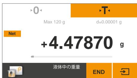
▶ ひょう量表示部に**液体中の重量**(ひょう量値)のステップが表示されます。
