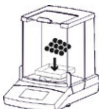
▶ 容器から最初のサンプルを取り除き、次のサンプルを容器に載せます。
