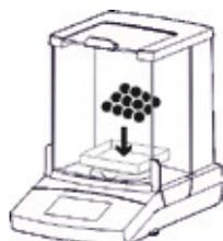
▶ 最初のサンプルを容器に載せます。
