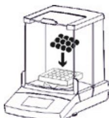
▶ 未知の個数のサンプルをひょう量皿の容器に載せます。
