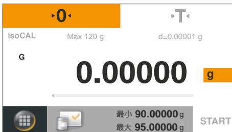
▷ チェックひょう量アプリケーションが表示されます。設定済みのしきい値が最小および最大に表示されます。
