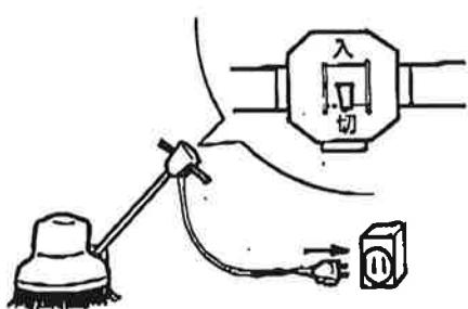
6. 作業を中断したり、終了したときはプラグをコンセントから取外しコードを巻きとって下さい。ハンドルは直立の位置に戻し車輪もおろして下さい。
