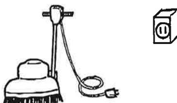
3. ハンドルを運転しやすい位置に固定して下さい。また、昇降式の車輪は上げて下さい。スイッチを入れると回転します。
