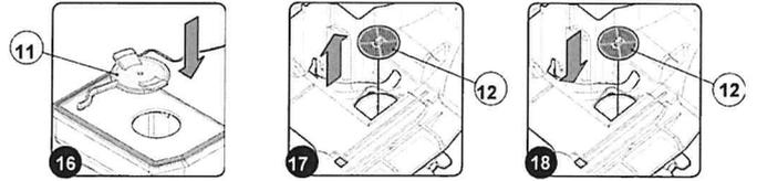
24. 洗浄液タンクを先に本体に戻し、のち汚水回収タンクを戻す
