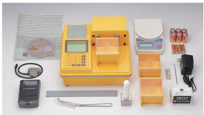
生コンをセットする 平らにならす スイッチを入れ、ふるいを振動させる モルタル試料の完成
