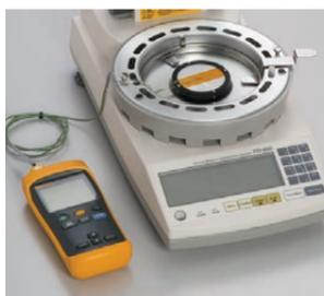
本体に搭載されている放射温度計の校正が可能です。専用の加熱標準体とデジタル温度計のセットです。
