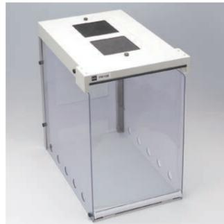
脱臭風防ケースFW-100は、ケット製赤外線水分計を内部に設置して測定することができます。質量センサが外部から受ける気流による外乱要因を低減させることができ、また、上部に脱臭フィルタを設けてあるため、加熱乾燥時に発生する臭気を軽減させることができます。
