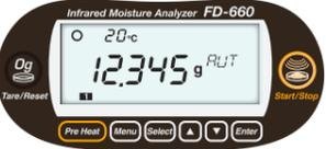
測定準備完了の画面です。表示部には、質量が表示されます。Start/Stop キーを押すと、測定が始まります。
