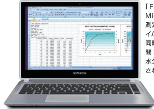
「FDL-02」により、Microsoft Excelに測定データがリアルタイムで書き出されます。同時に、時間：温度、時間：質量変化量、時間：水分値のグラフも作成されます。
