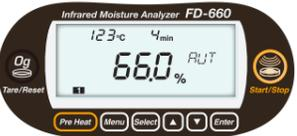
測定中の画面です。表示部には、水分値が表示されます。再度キーを押すと測定を中止します。
