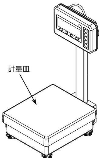
**10** 水平器を確認しながらアジャスタを回し、はかりを水平に調整する
