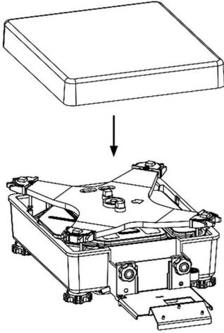
**6** 表示部を図のように表示部取付金具に取り付ける
