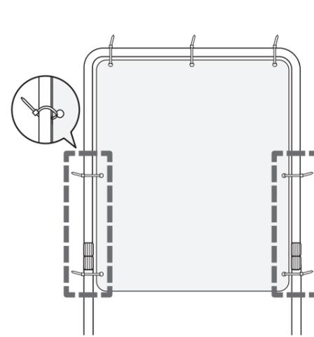
**8** 最後に、「結束バンドの飛び出ている部分」をハサミやニッパーで切り取り、凸部分を内側に回し穴部分に入れて完成です。
