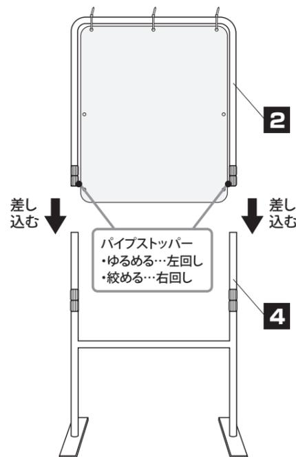
**6** 設置場所に配置し、本体の高さを調節してください。
