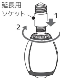
付属の延長用ソケットを本体に取り付けてから、E26ソケットに取り付けてください。
