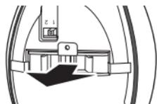
カバーをはずして光触媒フィルターを取りはずす
