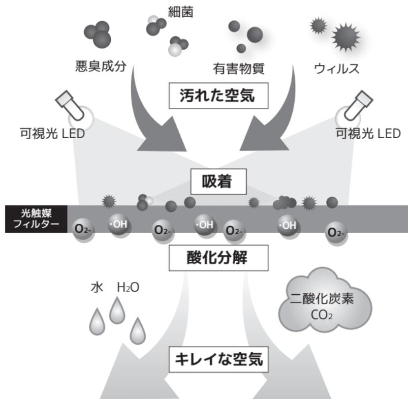
光触媒フィルターに光を照射すると、強力な酸化力を帯びるようになります。この光触媒が持つ強い酸化能力を利用して、空気中の悪臭成分や有害物質などを分解することができます。
