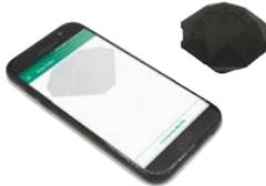
ニクスProカラーセンサーの指定アプリをダウンロード後アプリを起動し、Bluetoothを使用してProを接続します。
