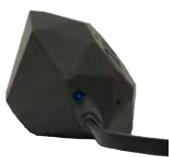
ニクスProは「スリープ」状態で工場から出荷されます。標準の充電ケーブルに接続する事により起動します。
