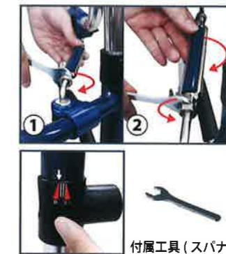
①ハンドル角度調節は、ターンバックル両端のナットを付属品のスパナで時計回り(写真①)に回して緩めてください。ターンバックルを反時計回りに回転させるとハンドル角度が広がります。位置が決まつたら、両サイドのナットを指でターンバックルに接触するまで締め付けた後付属工具のスパナでターンバックルが動かないよう締め付けてください。
