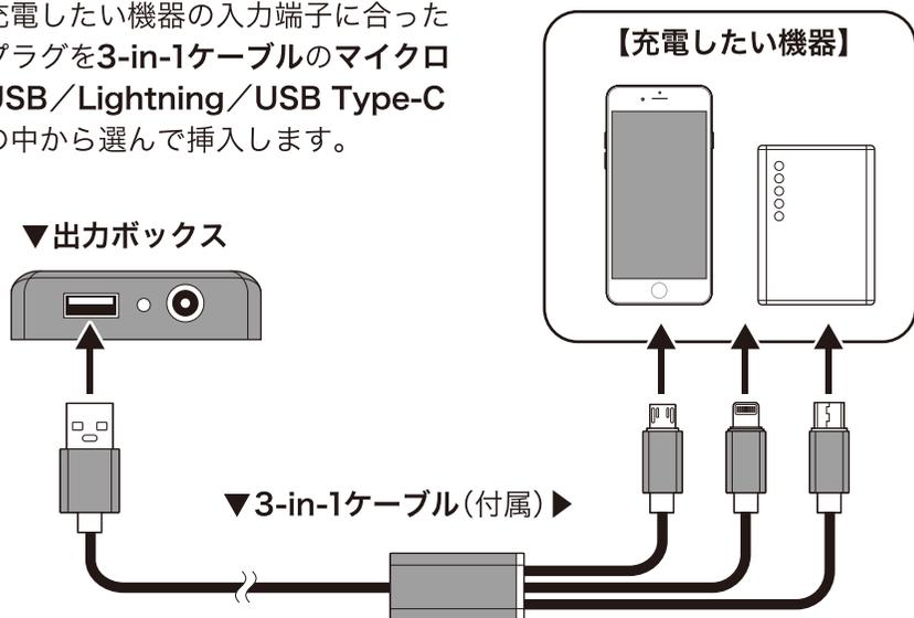
例) 電池容量3,000mAhのスマートフォンの場合、約3時間で満充電になります。
